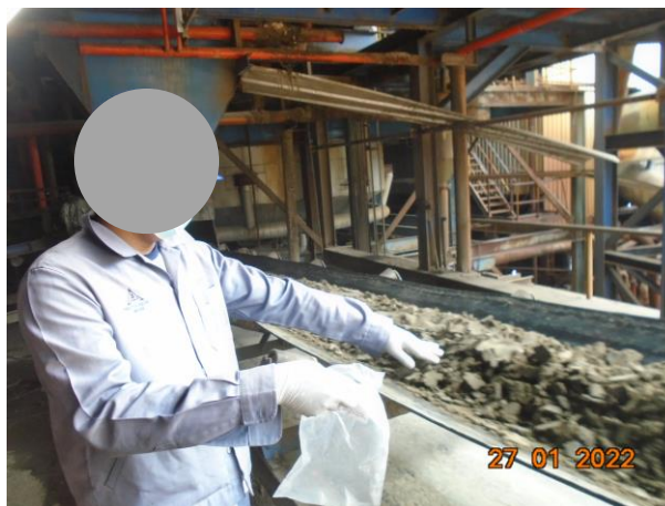
รูปที่ 3.4-15 การเก็บตัวอย่างกากตะกอนหม้อกรองจากกระบวนการผลิตของโครงการ
